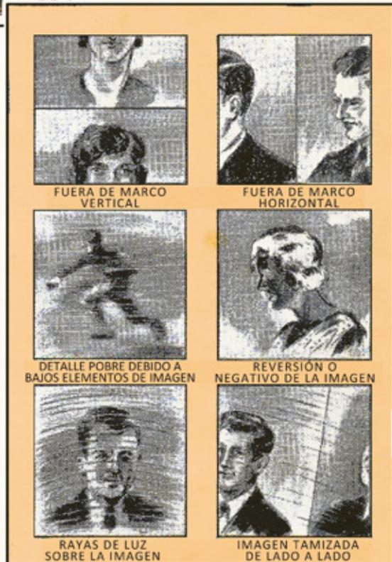
Los dibujos muestran las dificultades más relevantes que aún se registran en la recepción de televisión. Al recibir la señal del motor de escaneado, si la sincronización con la transmisión se pierde, las imágenes van de lado a lado, o alteran sus encuadres vertical y horizontal. Las imágenes con detalles pobres por lo general se deben a un insuficiente número de líneas en el disco transmisor de barrido.
